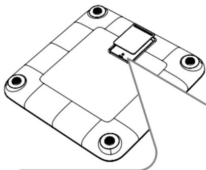
Wenn Sie die Maßeinheit ändern möchten, können Sie die Taste im Batteriefach drücken, um zwischen Pfund, Kilogramm und Stones zu wechseln.
