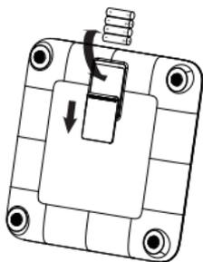
Legen Sie vier AA-Batterien in die Rückseite der Waage ein.
