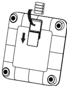
Inserisci quattro batterie AA nel vano sul retro della bilancia.
