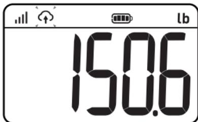
Durante la trasmissione, sul display della bilancia lampeggerà l'icona
