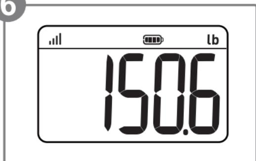
Une fois que la mesure est verrouillée, la balance l'enregistre et commence le processus de transmission des données.
