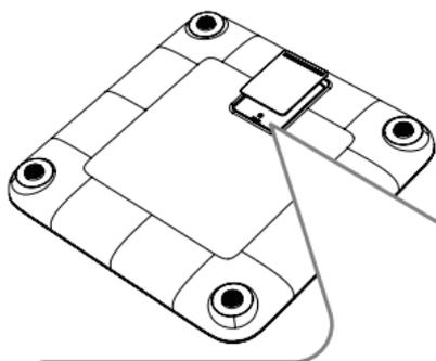
Se desideri cambiare l'unità di misura, puoi premere il tasto sul vano batterie per passare dai chili, alle libbre, allo stone.
